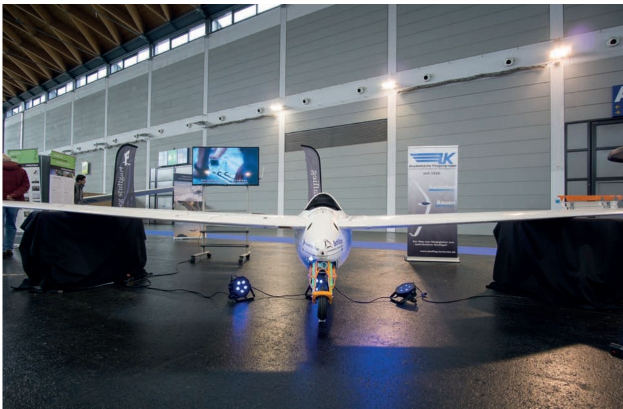
Fertiger Rumpf der AK X auf der Aero 2019 mit Bruchflügel (links Bildseite) und erster neuer Tragfläche.
